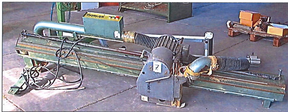
Obrázek 7 – Spodní okružní pila s pojezd. stolem a odsáváním STRIEBIG
